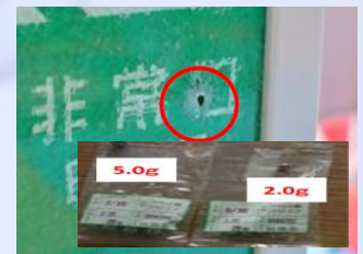
検証②-1 スリングショットで3m離れた位置からの衝撃試験（既設強化ガラス5t）
