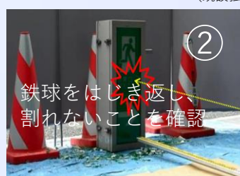
検証②-2 スリングショットで3m離れた位置からの衝撃試験（既設強化ガラス5t + 衝撃吸収シート）
