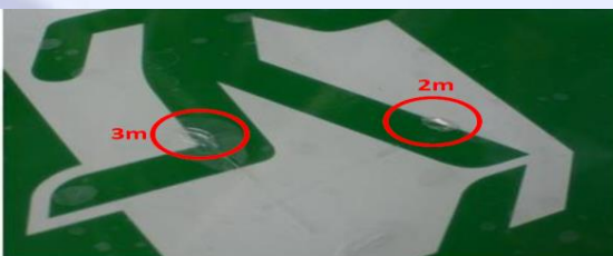
* 高さ3m位置でも実験：破損（無） 落下痕のみ
