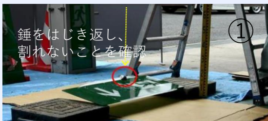
検証①-2 高さ2m位置からの錘落下試験（既設強化ガラス5t + 衝撃吸収シート）
