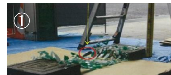
検証①-1 高さ2m位置からの錘落下試験 (既設強化ガラス:5t)
