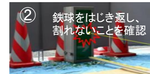
検証②-2 スリングショットで3m離れた位置からの衝撃試験 (既設強化ガラス5t+衝撃吸収シート)
