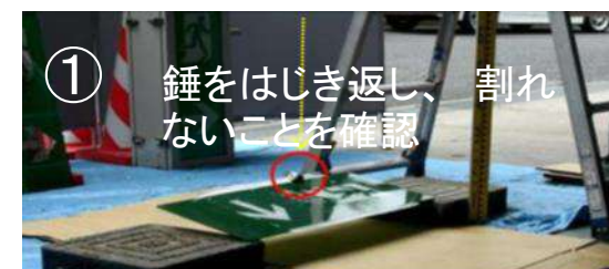
検証①-2 1高さ2m位置からの錘落下試験 (既設強化ガラス5t+衝撃吸収シート)
